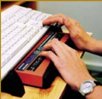
obr. 2 Braillový řádek pro čtení informací z počítače pomocí slepeckého písma (ve spojení s počítačem)
